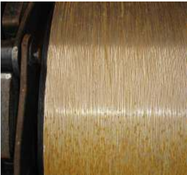
Acero al carbono en ingenio (después de 2 años)
